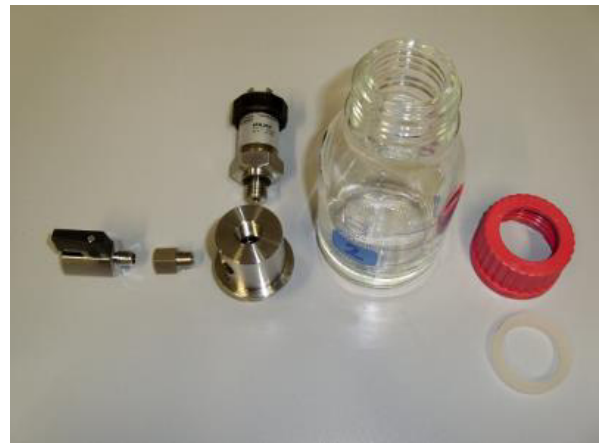
Bild 10: Links: Schematische Darstellung eines angeschlossenen Batchversuchs mit kontinuierlicher Druckaufzeichnung nach DIN EN ISO 11734 (Gasvolumenmessung mittels Gasdruckgerät) (VDI 4630, (2012)). Rechts: Kugelhahn mit Adapter für die Probenahme; Drucksonde zur Datenaufzeichnung, Probenflasche (in der Abbildung 250 ml), Schraubverschluss mit Gummidichtung
