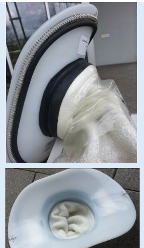
Für den o.a. Einsatzfall wird das abgebildete Hutprofil zur Verschlussplatte modifiziert.
